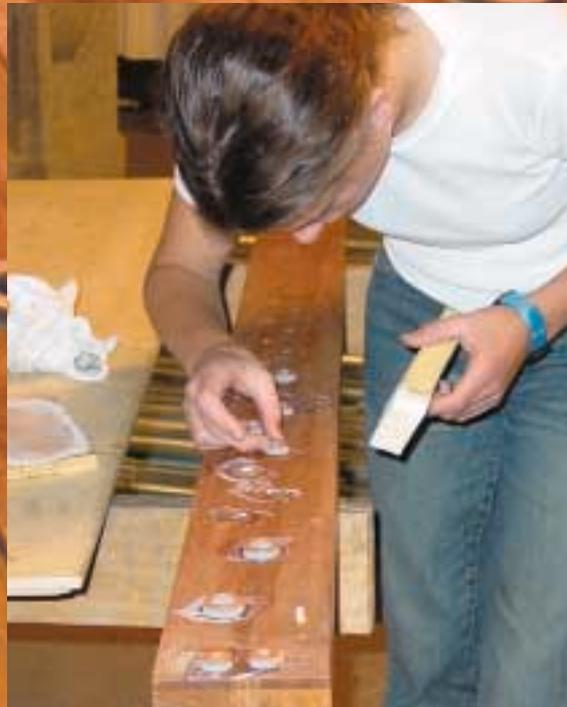
*Sämtliche Schleifendichtungen an den Unterseiten der Pfeifenstücke werden abgetragen und durch neue ersetzt.*
